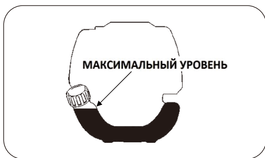
Рисунок 5. Максимальный уровень заполнения топливного бака.
