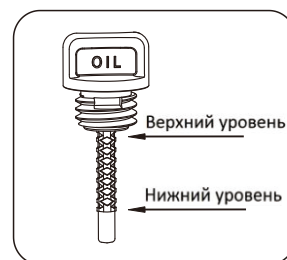
Рисунок 3. Отметки на масляном щупе.
