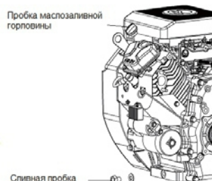
Рисунок 3. Проверка уровня моторного масла.
