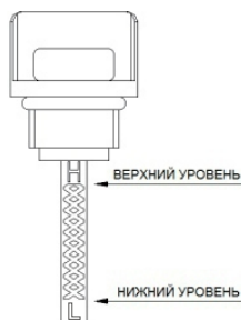
Рисунок 3. Отметки на масляном щупе.
