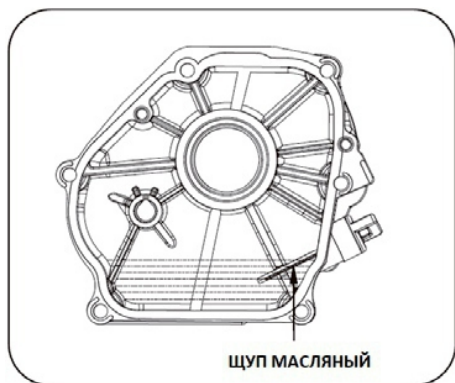
Рисунок 2. Проверка уровня моторного масла.
